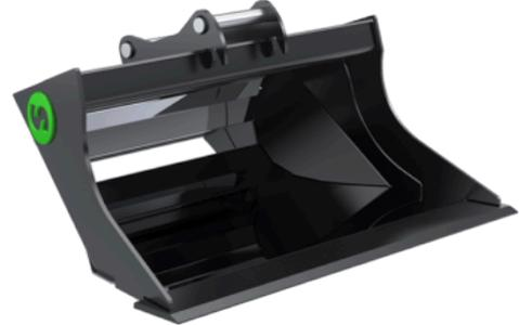
Sulle benne più grandi (dalla S60 in su) vengono utilizzati tubi sovradimensionati per aumentare la rigidità delle benne, mentre la struttura a traliccio in lamiera viene utilizzata sulle benne più piccole per tenere un peso basso.
